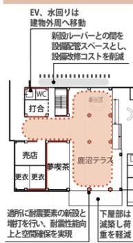
■図ウ-2 工事概算検討 ■図ウ-3 現新館改修イメージ
