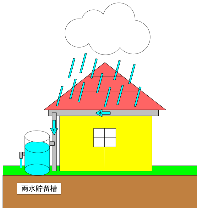
雨水貯留槽設置 イメージ図
